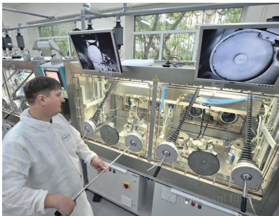
Роботизированная линия по производству микросточников на основе йода-125
