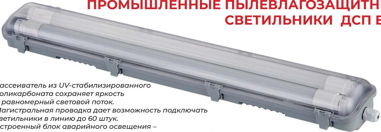
*Рассеиватель из UV-стабилизированного поликарбоната сохраняет яркость и равномерный световой поток. Магистральная проводка дает возможность подключать светильники в линию до 60 штук. Встроенный блок аварийного освещения – 3 часа автономной работы, 10% светового потока в аварийном режиме, постоянный и непостоянный режим работы.*
