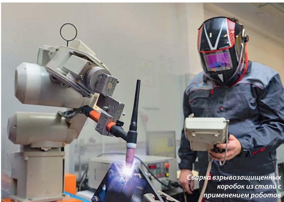
Сварка взрывозащищенного короба из стали с применением роботов
