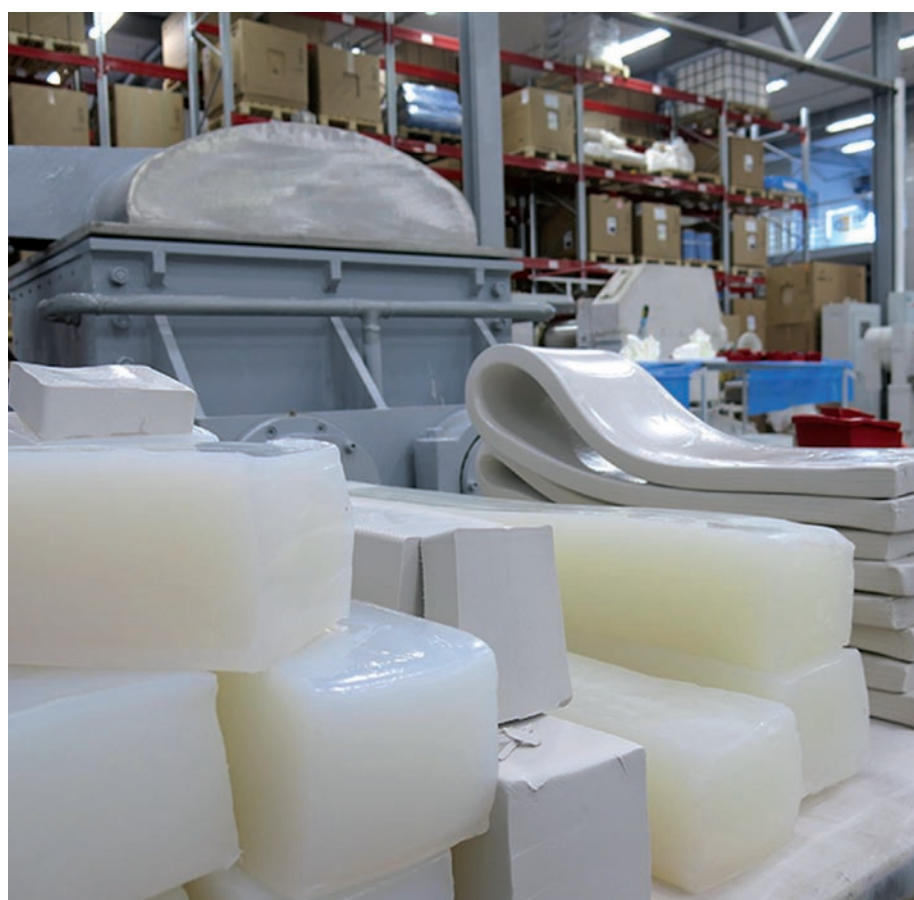
Неотвержденный полимер с наполнителем
