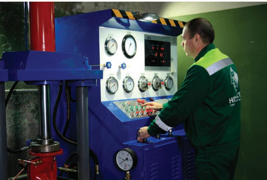
испытательный стенд позволяет осуществлять проверку на прочность и герметичность трубопроводной арматуры с типоразмерами до DN 300 и давлением до 460 бар. Конструкцией стенда предусмотрена возможность осуществлять настройку давления срабатывания предохранительных клапанов.
