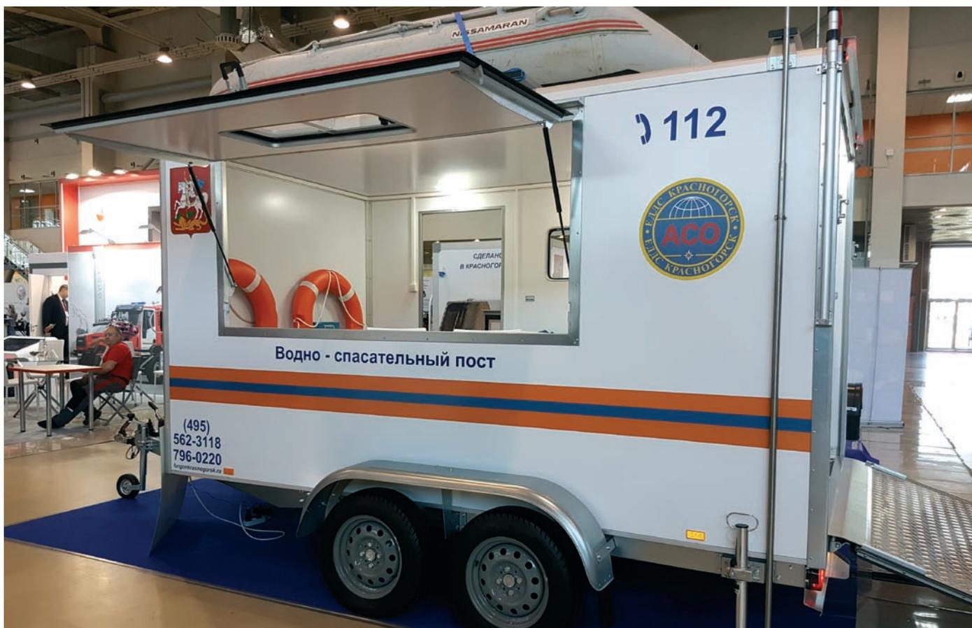
эргономичностью и комфортом. Высокий клиренс и колеса R16 позволяют ему преодолевать любые препятствия вслед за тягачом, а наружная облицовка из рифлёного алюминия надёжно защищает фургон от веток и камней.
