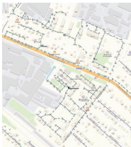
Пример электронного моделирования схемы сетей наружного освещения
