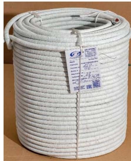
*Провод ПАЛ – одножильный, многопроволочный гибкий провод с применением в качестве изоляции обмотки из упрочненной асбестовой ровницы, пропитанной термостойким лаком, ориентированной пленки из фторопласта Ф-4 и обмотку из асбестовой пряжи, пропитанной эмалью. Выдерживает агрессивные среды и температурный режим работы от -50°C до +200°C. Сечение в диапазоне от 1 до 25 мм.*
