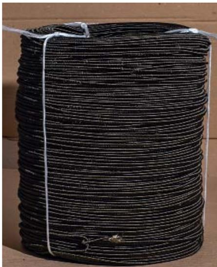
*Провод ПТБ – это провод с термостойкой базальтовой изоляцией, в более экологичном исполнении по сравнению с ПАЛ. Выдерживает температурный режим от -50°C до +300°C. Сечение в диапазоне от 1 до 25 мм.*
